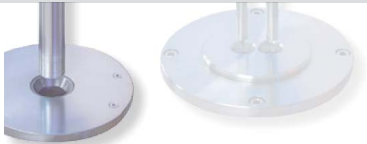
单或多料筒系统用于测定流动和粘度
