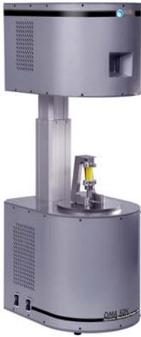
DMA 50 是一款台式动态机械分析仪，以大力值范围和强适应性为其主要特点。从玻璃化转化温度到浸渍试验，提供材料热机械性能测试平台。
