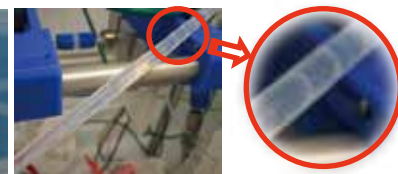
两相在普通管道式反应器中的混合效果
